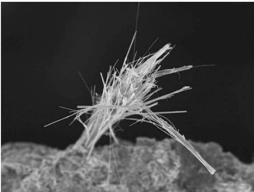
Esimerkkikuva. Asbestikuituja rakennusmateriaalissa (Mikrofokus Oy).
