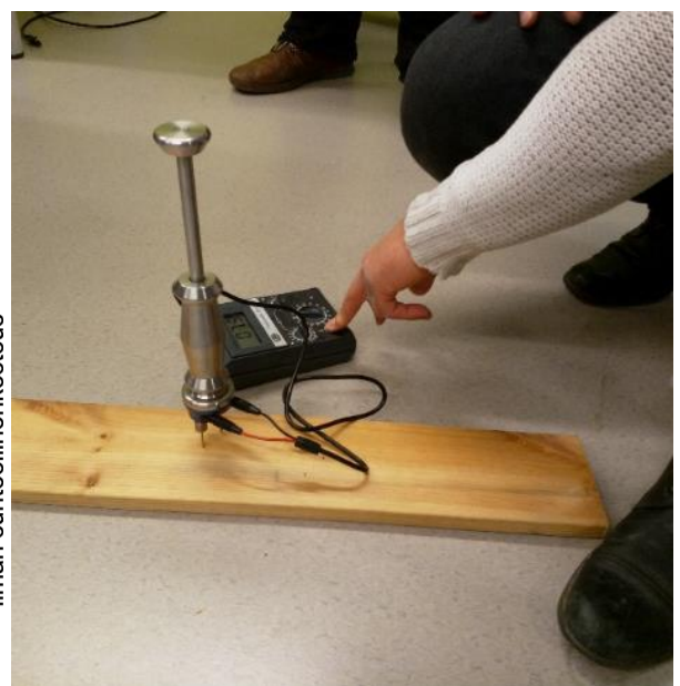
Kuvaaja. Puun kosteuspitoisuus ympäröivän ilman lämpötilan ja suhteellisen kosteuden suhteen (Puuinfo). Oikealla esimerkkikuva puun kosteusmittauksen toteutuksesta.
