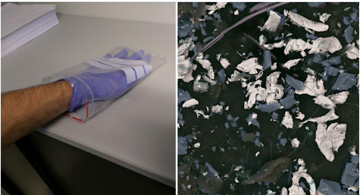
Esimerkkikuva. Vasemmalla pölynäytteenotto tasopinnalta (FCG Oy). Oikealla näytteen koostumuksen analyysi elektronimikroskoopilla (Mikrofokus Oy).
